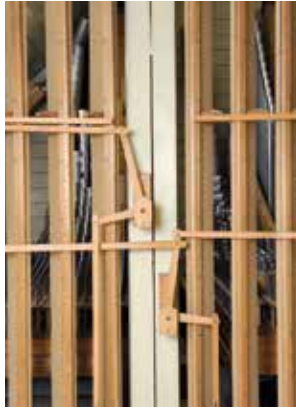
Das komplizierte Regelwerk der beiden Schalousieschweller ist feinste handwerkliche Arbeit!
