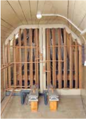
Blick auf die pneumatisch gesteuerten Schalousien des Fernwerks. Die beiden kleinen Bälge für die Steuerung sind im Vordergrund sichtbar.
